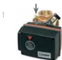
1 Для ручного управления клапаном нажмите на кнопку и поверните ручку. Электропитание будет автоматически отключено от привода до тех пор пока кнопка находится в нажатом положении.
