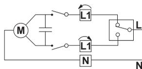
Электроприводы с вспомогательным выключателем
