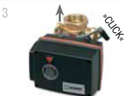
3 Для возвращения в автоматический режим управления поверните ручку управления в крайнее положение до щелчка, при этом кнопка вернется в первоначальное состояние. Питание к приводу снова подается.
