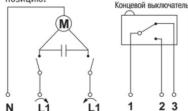
Электропривод со встроенным реле, Арт. No. 1205 25 00, 1205 26 00
