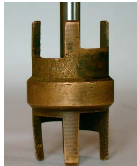
Цинк вымывается из латуни при высоком уровне pH.
