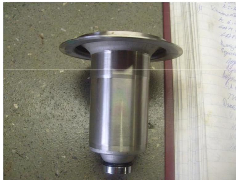
Все детали мотора выделяются следами точения.
