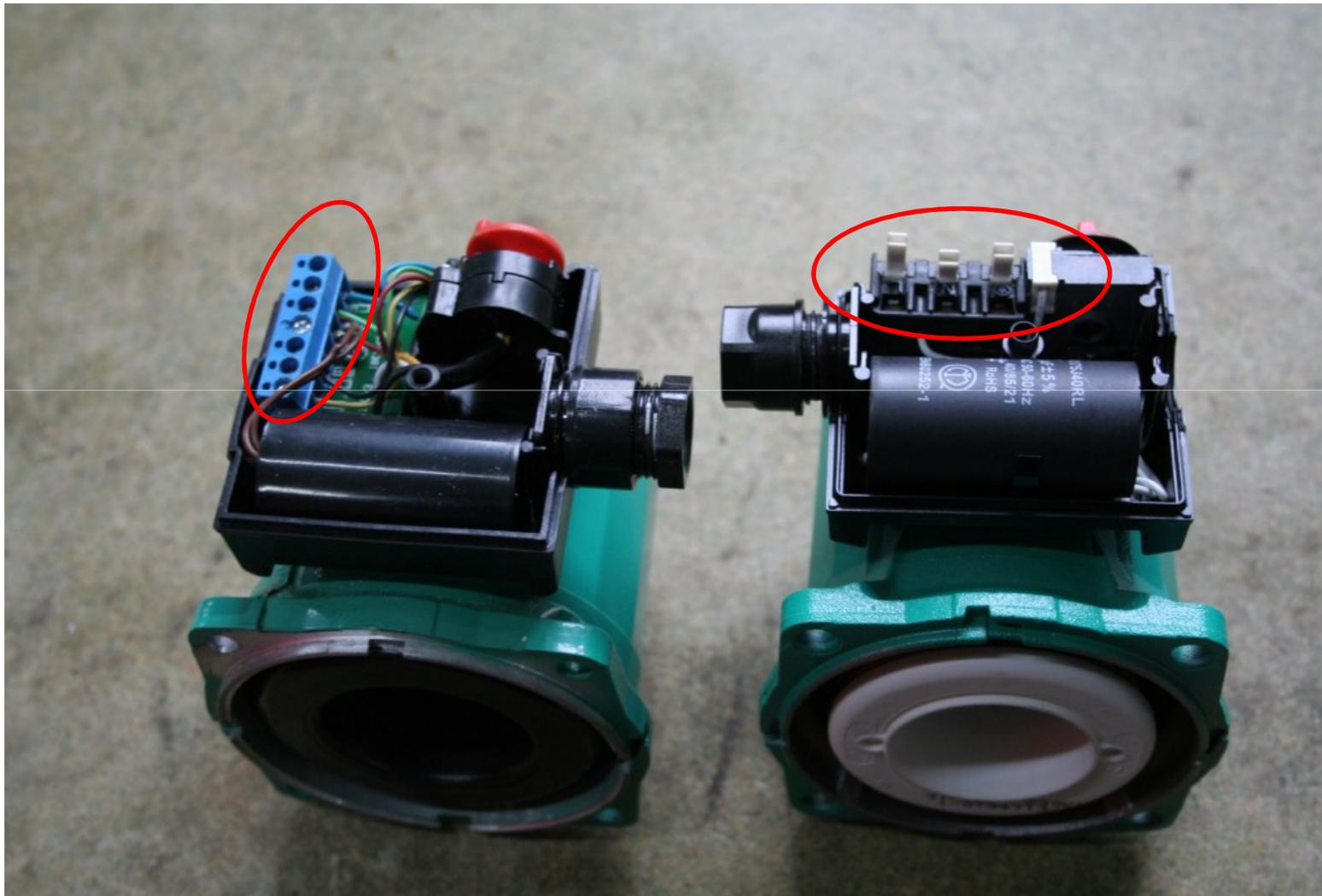
Клемная коробка поддельных насосов (слева) имеет конструктивные отличия от оригинальной клемной коробки, соответственно различается способ закрепления клемных коробок на корпусе статора.
