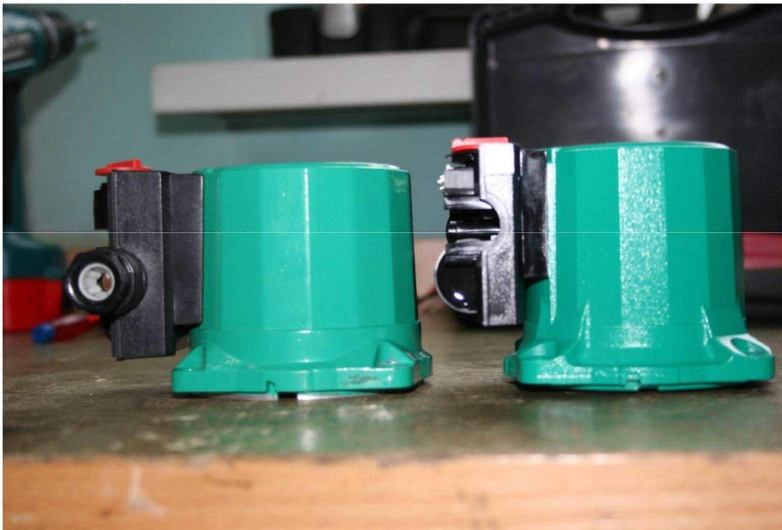
Рабочие колеса выполнены из разных материалов. Визуально, рабочее колесо оригинального насоса имеет белый цвет (справа). Гильзы насосов отличаются диаметрами и формой. Помимо всего, на гильзе оригинального насоса (справа) нанесен артикульный номер.
